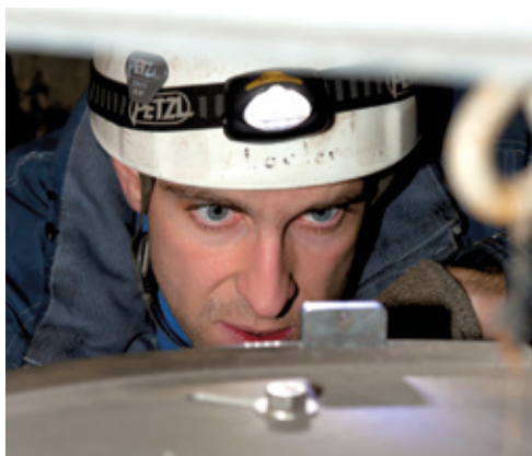
Surveillance à l'aide d'un pendule
