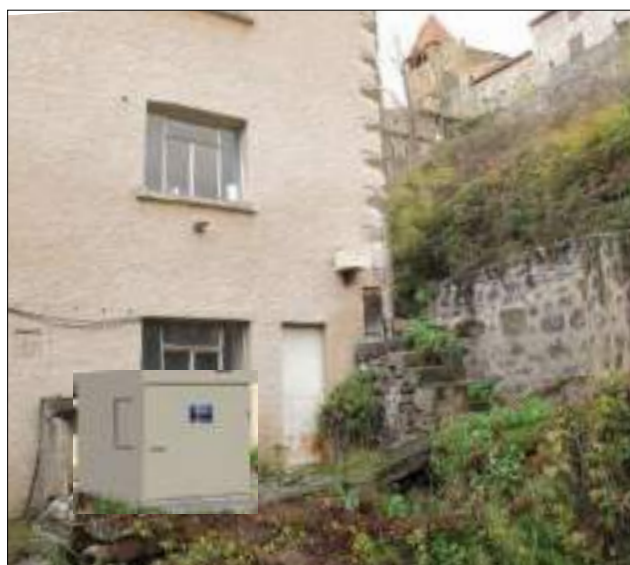
Photo 24 : Simulation des projets successifs de transformateur. Celui-ci fait 1,40 m de haut, 1,31 m de large et 1,44 m de profondeur.
