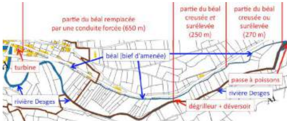
Figure 3 : Plan du béal et de la rivière Desges avec les différents aménagements prévus de l'amont (à droite) vers l'aval (à gauche).
